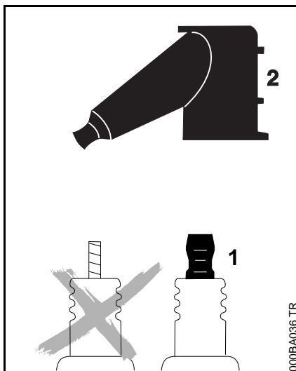
**⚠ Para reducir el riesgo de incendios y lesiones por quemadura, use solamente bujías autorizadas por STIHL. Siempre encaje un casquillo (2) del tamaño correcto bien ajustado en el borne (1) de la bujía. (Nota: Si el borne tiene una tuerca adaptadora SAE desprendible, colóquela.) Una conexión suelta entre el casquillo de la bujía y el conector del alambre de encendido puede formar un arco eléctrico, inflamar los vapores combustibles y finalmente causar un incendio.**
