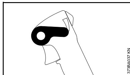
Palanca de ajuste en la posición de ralentí.
