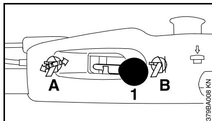
La regulación de la profundidad de corte se acciona con la
