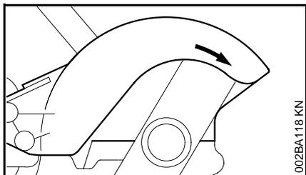
Siempre revise la condición y funcionamiento de su orilladora antes de ponerla en marcha, especialmente el gatillo de aceleración, el bloqueo del gatillo de aceleración (y si lo tiene, el interruptor de parada, la herramienta de corte, el deflector y el arnés). Una **flecha** en el deflector indica el sentido correcto de giro de la cuchilla.
