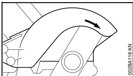
Siempre revise la condición y funcionamiento de su orilladora antes de ponerla en marcha, especialmente el gatillo de aceleración, el bloqueo del gatillo de aceleración (y si lo tiene, el interruptor de parada, la herramienta de corte, el deflecto y el arnés). Una **flecha** en el deflecto indica el sentido correcto de giro de la cuchilla.
