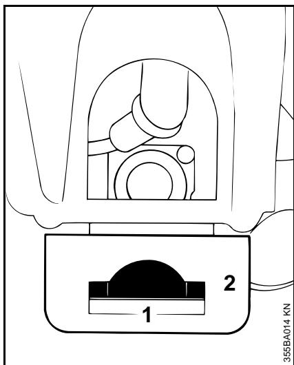
La suciedad en el filtro de aire reduce la potencia del motor, aumenta el consumo de combustible y dificulta el arranque del motor.
