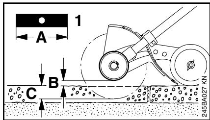
Una cuchilla combada o con roturas no deberá enderezarse ni soldarse – ¡Esto puede hacer que se rompa por completo! Las cuchillas en ese estado deben sustituirse (vea el capítulo "Colocación de la cuchilla"). Utilice exclusivamente cuchillas originales STIHL con número de pieza 4133 713 4101 (con marcas 33/01).
