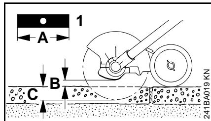
Una cuchilla combada o con roturas no deberá enderezarse ni soldarse – esto puede hacer que se rompa por completo. Las cuchillas en ese estado deben sustituirse – vea "Colocación de la cuchilla de la orilladora".
