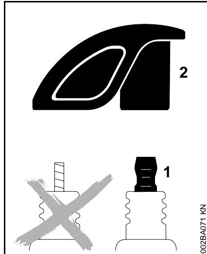
**⚠** Para reducir el riesgo de incendio y de quemaduras, utilice solamente las bujías autorizadas por STIHL. Siempre inserte el casquillo (2) de la bujía bien apretado en el borne (1) del tamaño adecuado. (Nota: Si el borne tiene una tuerca adaptadora SAE desmontable, tiene que ser instalada.) Una conexión suelta entre el casquillo de la bujía y el conector del cable de encendido en el casquillo puede crear un arco voltaico y encender los vapores del combustible, provocando un incendio.
