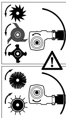
En las herramientas de metal (ilustración superior), coloque la caja de engranajes de modo que el eje quede bajo el tubo de mando.
