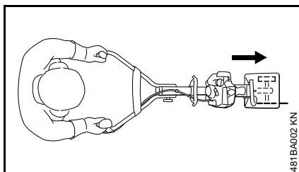
Trabaje moviendo el motor MultiEngine con la bordeadora FC-MM en el sentido de avance solamente.
