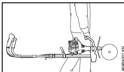
Sujete la herramienta motorizada por la argolla de transporte, con el accesorio hacia delante.
