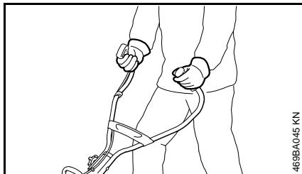
Cuando trabaje con ella, siempre sujetela máquina firmemente colocando ambas manos en los mangos. Envuelva firmemente los mangos con todos los dedos, manteniéndolos sujetos entre los dedos índice y pulgar. Mantenga las manos en esta posición, para tener la herramienta motorizada siempre bien controlada.
