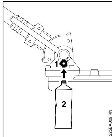
Para lubricar la **transmisión angular**, use lubricante para engranajes STIHL especial para cortadoras de matorrales\*\*, aproximadamente cada 25 horas de funcionamiento.
