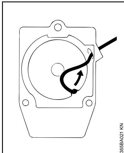
El mango de arranque debe quedar firmemente sentado en el buje guía de la cuerda. Si el mango cae hacia un lado: Dele una vuelta adicional al rotor de la cuerda para aumentar la tensión del resorte.
