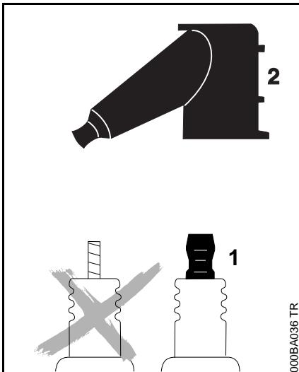
**⚠** Para reducir el riesgo de incendios y lesiones por quemadura, use solamente bujías autorizadas por STIHL. Siempre encaje un casquillo (2) del tamaño correcto bien ajustado en el borne (1) de la bujía. (Nota: Si el casquillo tiene una tuerca adaptadora SAE desprendible, colóquela.) Una conexión suelta entre el casquillo de la bujía y el conector del alambre de encendido puede formar un arco eléctrico, inflamar los vapores combustibles y finalmente causar un incendio.
