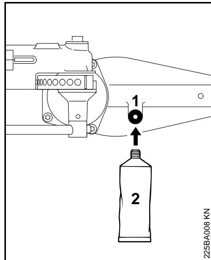
Para lubricar el **engranaje impulsor de la cuchilla** use lubricante para engranajes STIHL especial para cortasetos\*\*, aproximadamente cada 25 horas de funcionamiento.
