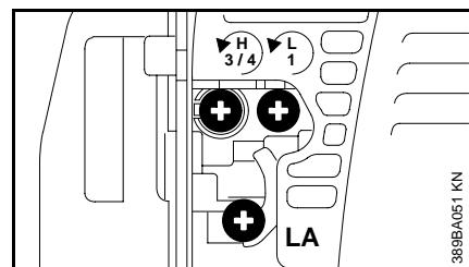
Puede ser necesario efectuar un ajuste ligero del tornillo de velocidad alta (**H**) si la potencia del motor no es adecuada para trabajar en grandes altitudes.
