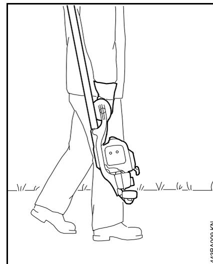
Puede acarrearla solamente en posición vertical. Agarre el mango delantero y mantenga el silenciador caliente lejos de su cuerpo y las cuchillas del accesorio de corte detrás de usted.
