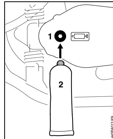
Para lubricar el engranaje impulsor de la cuchilla, utilice lubricante de engranajes STIHL para cortasetos (vea "Accesorios especiales").
