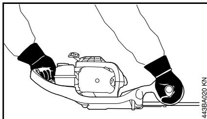
La mano izquierda sobre el mango de control y la derecha sobre el mango delantero.
