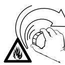
Las vibraciones de la máquina pueden aflojar una tapa de combustible que ha quedado mal apretada, o simplemente soltarla y derramar combustible. Para reducir el riesgo de derrames e incendio, apriete la tapa de llenado de combustible a mano tan firmemente como sea posible.
