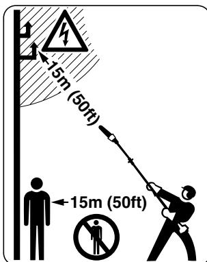
La electricidad puede saltar de un punto a otro al formar arcos en el aire. Los niveles altos de voltaje aumentan la distancia sobre la cual la electricidad puede formar arcos. La electricidad también puede conducirse por las ramas de un árbol, especialmente si éstas están húmedas. Guarde una distancia no menor de 15 m (50 pies) entre el podador (incluyendo las ramas con las cuales tenga contacto) y todas las líneas que conduzcan corriente eléctrica.
