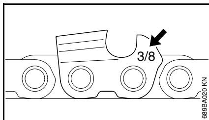
El paso de la cadena (por ejemplo: 3/8) se encuentra marcado en el lado del calibrador de profundidad de cada cortador.
