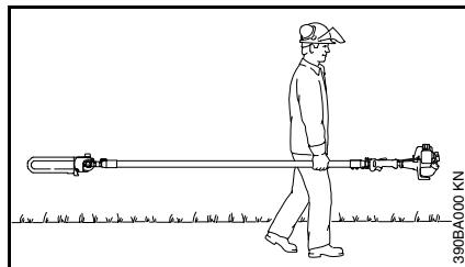
**Por mano:** Cuando acarree el podador a mano, apague el motor y colóquelo en la posición correcta. El protector de la cadena (funda) debe estar cubriendo la cadena y la barra guía, la cual debe estar apuntando hacia atrás. Cuando acarree el podador de varilla, la barra debe quedar detrás de usted.
