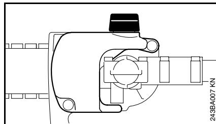
**El tanque de aceite de cadena lleno sólo tiene suficiente aceite para la mitad del tiempo de funcionamiento de la máquina con el tanque de combustible lleno. Por lo tanto, revise el nivel de aceite periódicamente durante los trabajos de corte. Nunca permita que se agote el aceite del tanque.**
