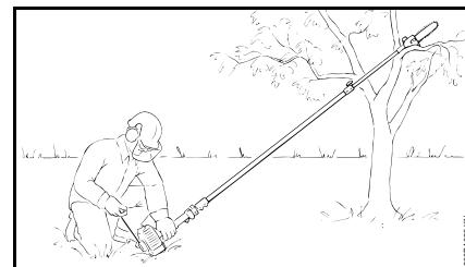
Coloque el podador de varilla sobre suelo firme u otra superficie dura en una zona despejada, o en la posición alternativa mostrada en la ilustración anterior. Mantenga buen equilibrio con los pies bien apoyados.
