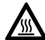
La caja de engranajes se calienta durante el funcionamiento de la máquina. Para reducir el riesgo de sufrir lesiones por quemaduras, no toque la carcasa de la caja de engranajes cuando está caliente.
