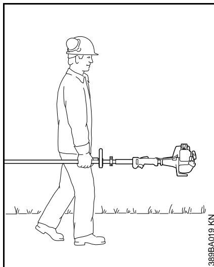
La herramienta se debe cargar siempre en posición horizontal. Agarre el mango de forma que la máquina se mantenga equilibrada en horizontal. Mantenga el silenciador caliente alejado de su cuerpo y el accesorio de corte, detrás de usted.
