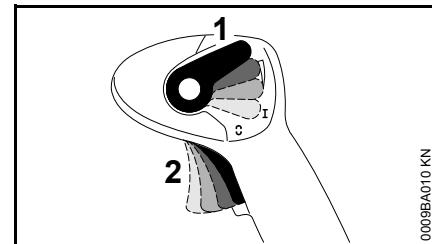
El gatillo del acelerador (2) puede trabarse en cualquier posición:
