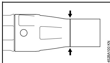
El extremo delantero de la boquilla se desgasta debido al contacto con materiales abrasivos en el suelo durante el uso. La boquilla está expuesto a desgaste normal y debe sustituirse cuando se alcanza la marca de desgaste.
