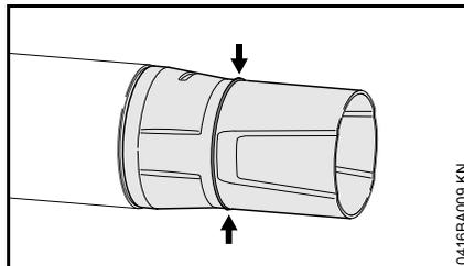
El extremo delantero de la boquilla se desgasta debido al contacto con materiales abrasivos en el suelo durante el uso. La boquilla está expuesta a desgaste normal y debe sustituirse cuando se alcanza la marca de desgaste.
