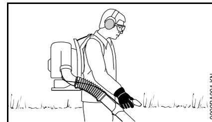
El soplador ha sido diseñado para usarse con una sola mano, con la mano derecha en el mango de control. Debe llevarse como una mochila, con las correas del arnés sobre los dos hombros.
